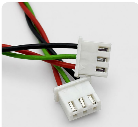
➤ Кабельная сборка на JST XH шаг 2.50 на дискретных проводах
