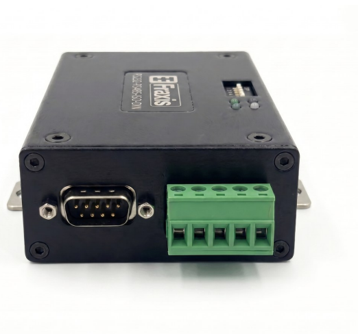
Передняя панель – DB-9 и клеммная колодка
